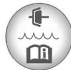
El tapón del depósito del fluido del embrague hidráulico tiene este símbolo. Vea en *Vista general del compartimiento del motor* ⇨ 251 la ubicación del depósito.
