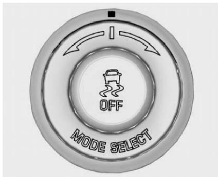
Para poder seleccionar esta opción de modo de conducción, el modo del vehículo debe ser Pista. Luego presione rápidamente el botón TCS/StabiliTrak
