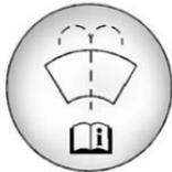
Abra el tapón que tiene el símbolo del lavaparabrisas. Agregue líquido para lavaparabrisas hasta llenar el tanque. Vea *Vista general del compartimiento del motor* ⇨ 251.
