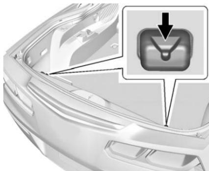
3. Alinee los pernos traseros del panel de techo para que caigan sobre los receptores en la parte trasera del área de almacenamiento.
