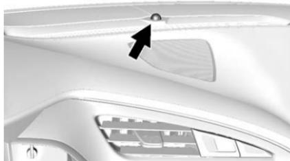
Hay un sensor de luz en la parte superior del tablero de instrumentos. No cubra el sensor, de otra manera los faros se encenderán cuando no sea necesario.
