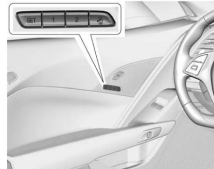
Si están instalados, los botones 1, 2, SET, y
