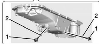
1. Tapones de vaciado del aceite del motor
