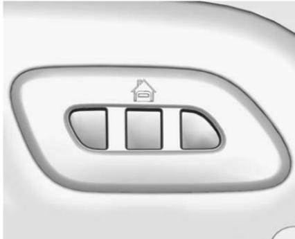
Este sistema, si está equipado, proporciona una forma de sustituir hasta tres transmisores de control remoto usados para activar dispositivos tales como abridores de puertas de cochera, sistemas de seguridad, y dispositivos de automatismo para el hogar.
