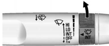
**INT (Limpiaparabrisas intermitentes)** : Mueva la palanca hacia arriba hasta INT para pasadas intermitentes, luego gire la banda
